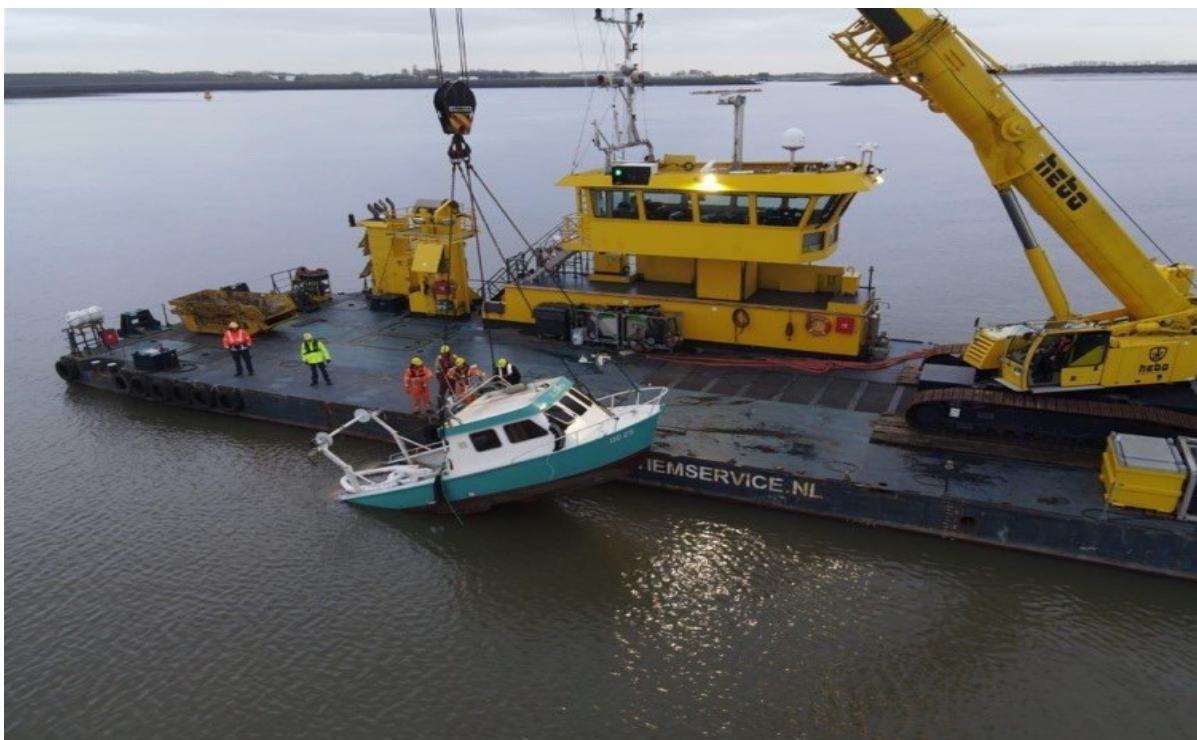
Figuur 16 Berging van een gezonken vaartuig bij de Haringvlietsluizen
