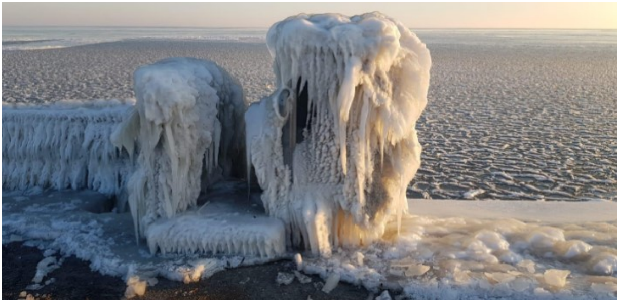
Figuur 11 Meetopstelling in het IJsselmeer met veel ijsafzet. Bron: Pieter Haaring
