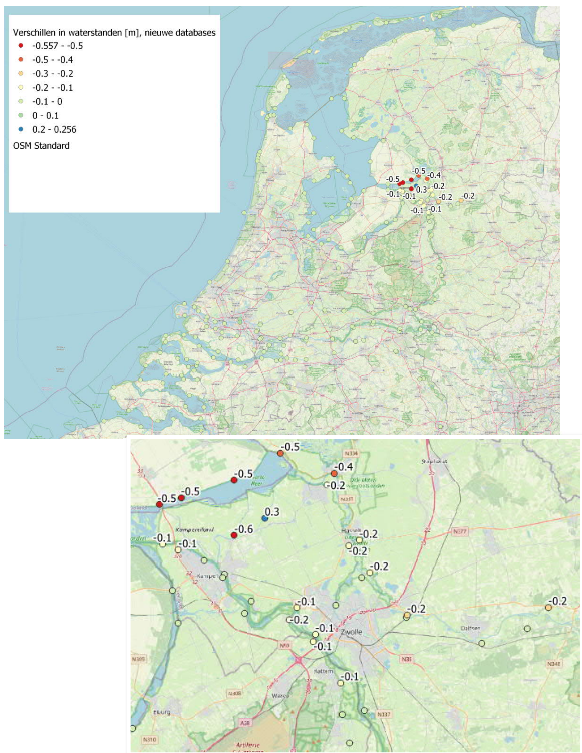
Figuur 1 Verschillen tussen de waterstanden bij de signaleringswaarde berekend met Riskeer 21.1.1 (nieuwe databases) en Riskeer 19.1.1 (huidige databases).
