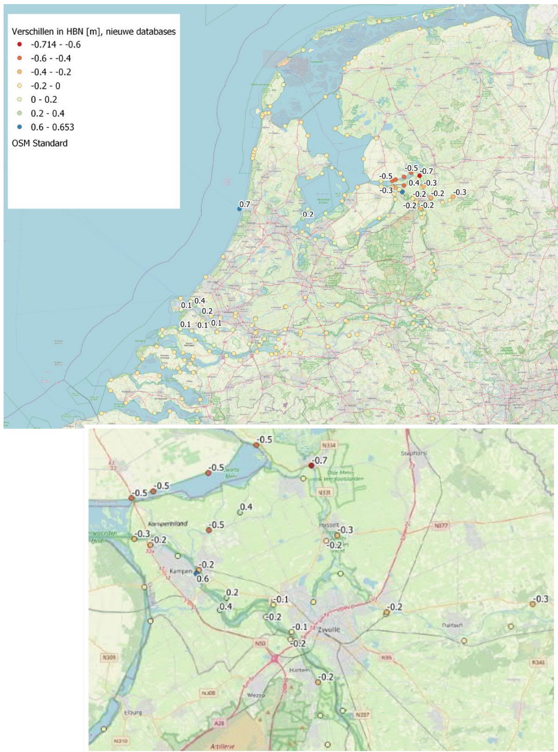
Figuur 3 Verschillen tussen de hydraulische belastingniveaus (HBN) bij de signaleringswaarde berekend met Riskeer 21.1.1 (nieuwe databases) en Riskeer 19.1.1 (huidige databases); kritiek overslagdebiet lognormaal verdeeld met gemiddelde 10 l/s/m en spreiding 5 l/s/m.
