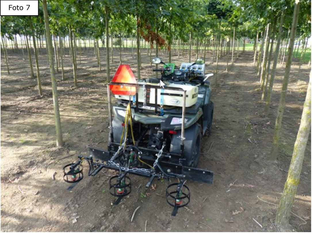
Foto 7: Quad met gedragen LvS GPS NK80LT.
