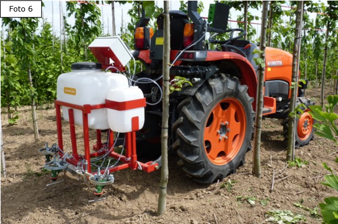
Foto 6: Smalspoor trekker met in driepunt gedragen LvS GPS NK80LT.
