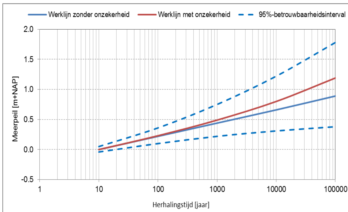
Figuur 7.13 Werklijn (blauw) en uit-geïntegreerde werklijn (rood) van het Markermeerpeil, inclusief het 95%-betrouwbaarheidsinterval.
