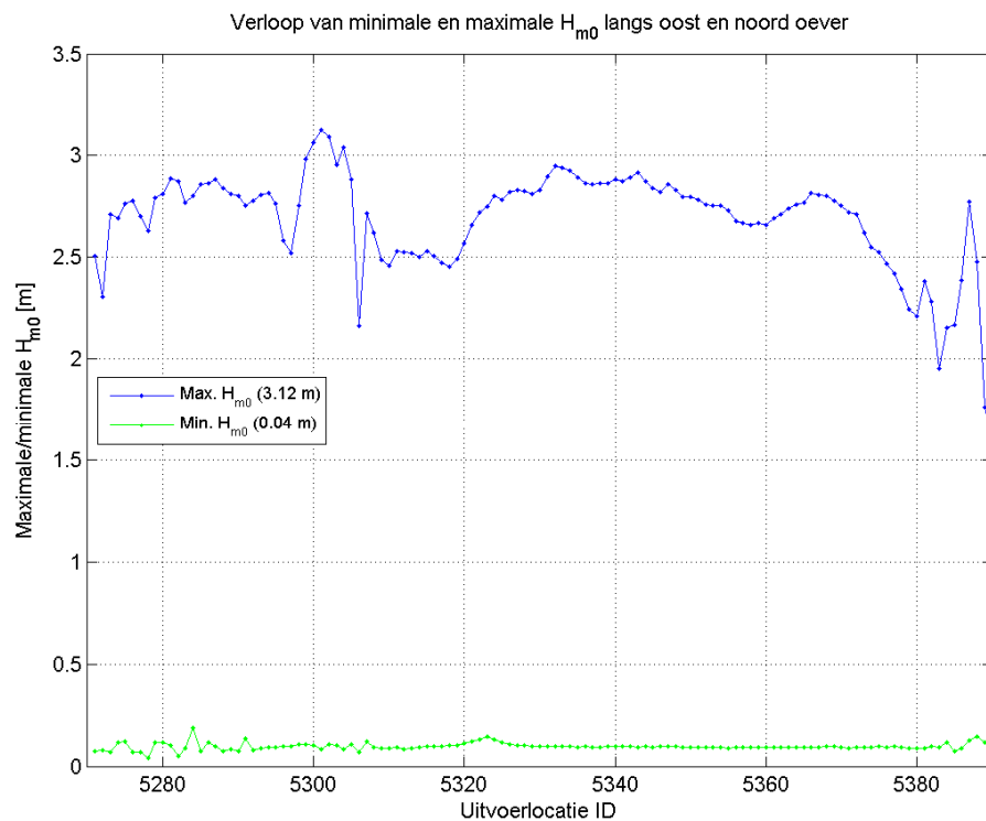
Figuur 4.11 Minimale en maximale significante golfhoogte in de uitvoerlocaties o.a. nabij de Ramspolkering bepaald over alle 392 berekeningen uit de YVO serie
