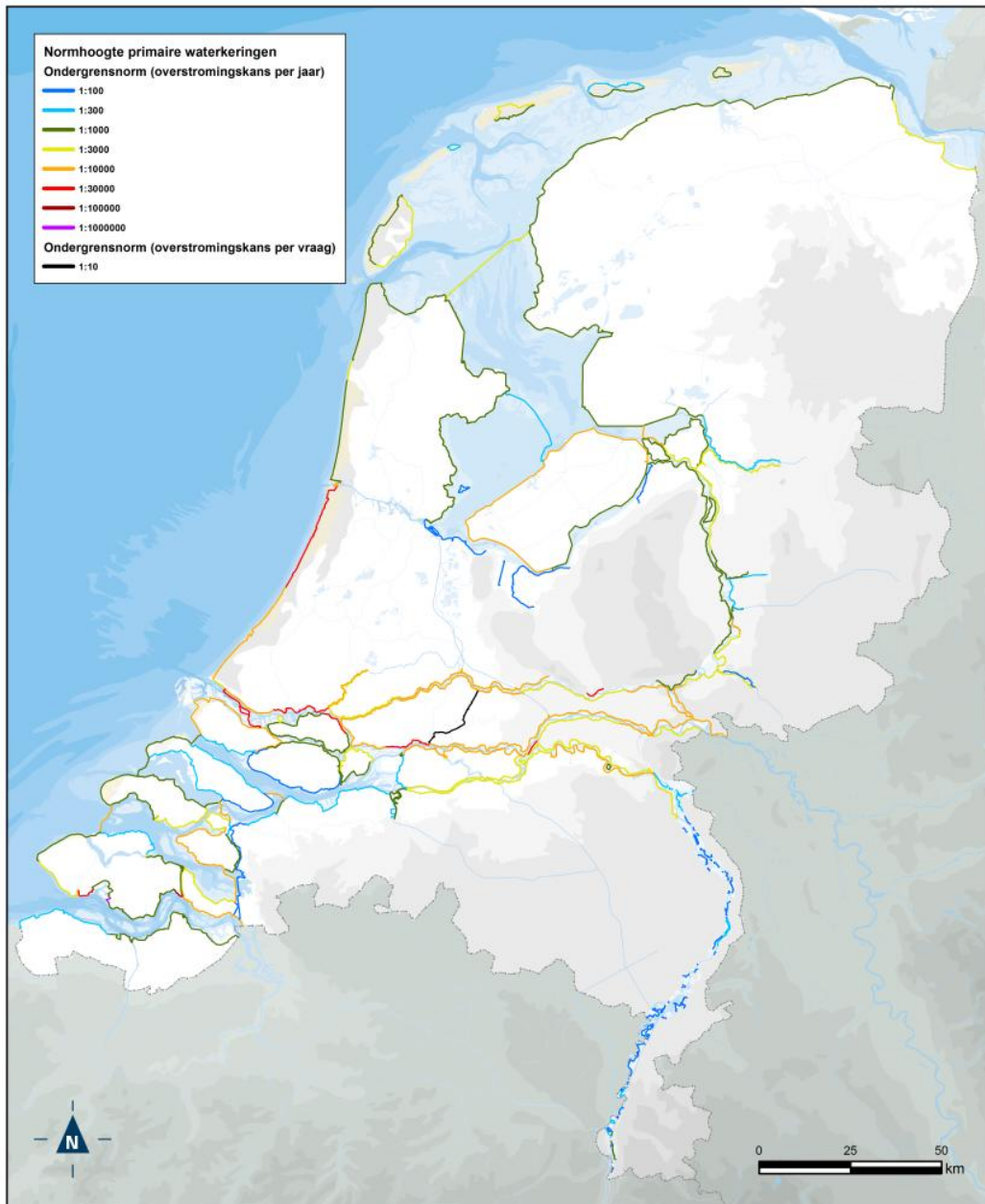
Figuur 1.1 Normfrequenties voor de primaire waterkeringen. Dit betreffen in dit geval de ondergrenzen, i.e. de maximale overstromingskans of faalkans, die hoort bij het beschermingsniveau dat voor het desbetreffende dijktraject toelaatbaar wordt geacht
