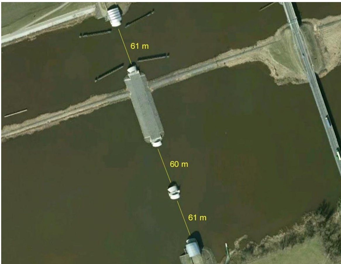
Figuur 2.4 Ramspolkering inclusief afmetingen van de openingen (gele lijnen).
