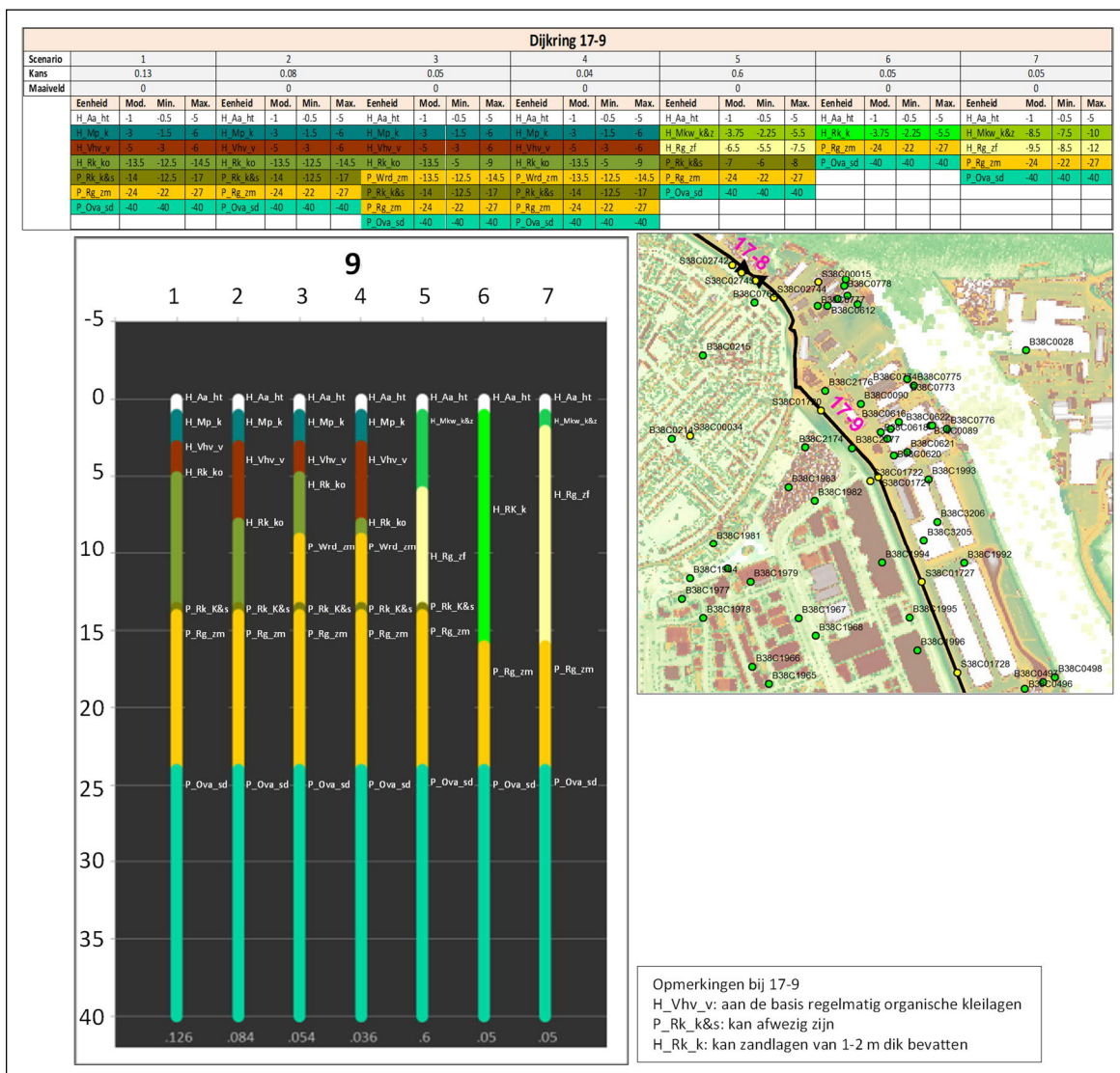
Figuur 5.2 Overzicht van de informatie die de SOS verschaft. In dit voorbeeld zijn zeven scenario's onderscheiden met een kans van aantreffen. Het bovenste tableau geeft per scenario van elk van de onderscheiden grondlagen de modale, minimum en maximum diepteligging weer. Het tableau linksonder is een weergave 'op schaal' van de grondlagen in de zeven scenario's, het tableau rechtsonder geeft een situatieschets met beschikbare grondonderzoekspunten
