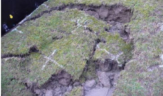
Figuur C.7 Uitspoelen van zand door een molgang onderaan het talud, gevolgd door ondermijning van de kleilaag en falen van de bekleding (Golfoverslagproef Tholen [6]).
