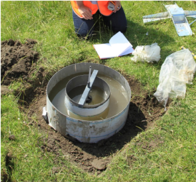
Figuur 6.1 Dubbele ring infiltrometer proef op de Afsluitdijk (foto Witteveen en Bos)
