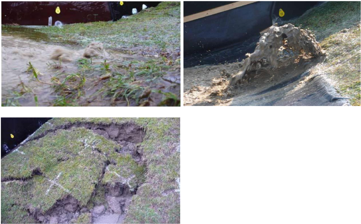
Figuur D.5 Uitspoelen van zand door een molgang onderaan het talud, gevolgd door ondermijning van de kleilaag en falen van de bekleding (Golfoverslagproef Tholen).
