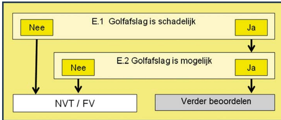
Figuur 22-1 Schema eenvoudige toets golfafslag bij voorlanden (VLGA).
