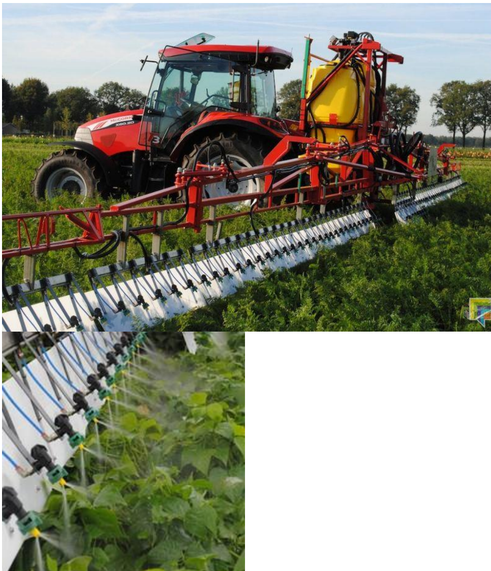
Figuur 4: Foto's van veldspuit met Wingssprayer type Single Wing-systeem in werking in een gewas
