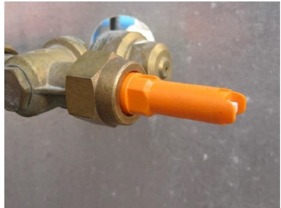
Foto's 3, 4 en 5: Bevestiging van de spuitdoppen op de spuit en reflectiescherm met spuitdoppen; rode cirkel is sensor (anemometer) voor meten luchtsnelheid in reflectiescherm
