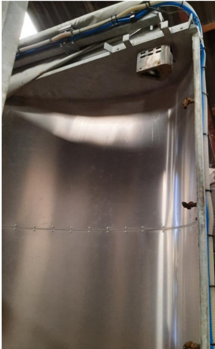
Luchtsnelheidsensor meet de luchtsnelheid uit het reflectiescherm rechts.
