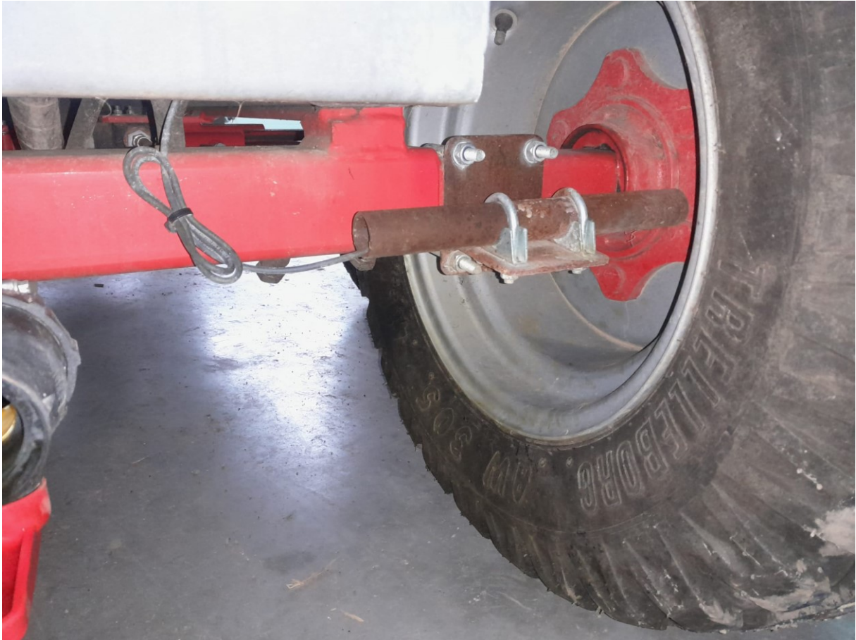
Wielensensor, gemonteerd op de vaste (achterste) wielas aan de rechterzijde
