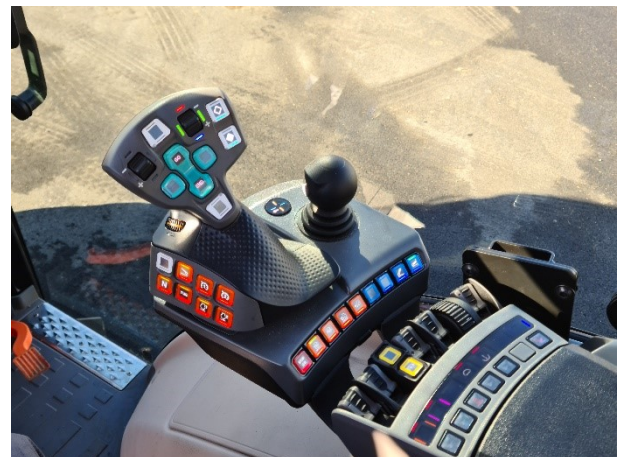
FIGUUR 4 Regeling van de oliehoeveelheid op een Fendt-tractor 1
