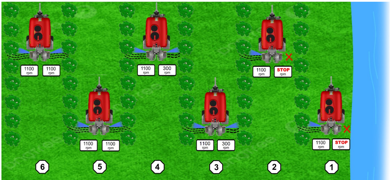
FIGUUR 9 Aangepaste instellingen van het maximale toerental van de ventilatoren voor luchtondersteuning in de buitenste 4 rijpaden (werkgangen) en eenzijdige bespuiting buitenste fruitgewasrij; vanaf rijpad 5 is het maximale toerental van de ventilatoren aan beide zijden 1100 rpm.
