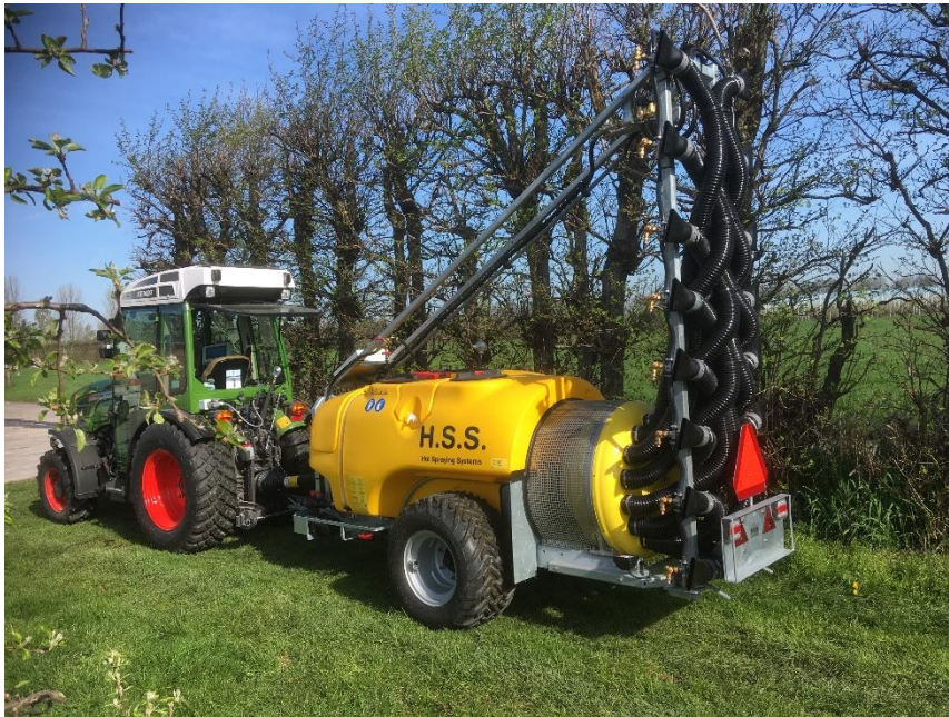
Foto 3: Dwarstroomspuit met volledige luchtuitstroomopbouw
