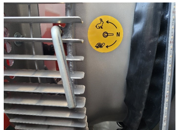
FIGUUR 4 Hendel en sticker van de versnellingsbak voor de ventilator van de luchtondersteuning; op de foto staat de hendel in de lage stand (schildpad-stand)
