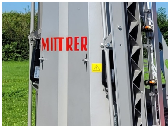
FIGUUR 3 Luchtkleppen van het Air Reduction System (ARS)
