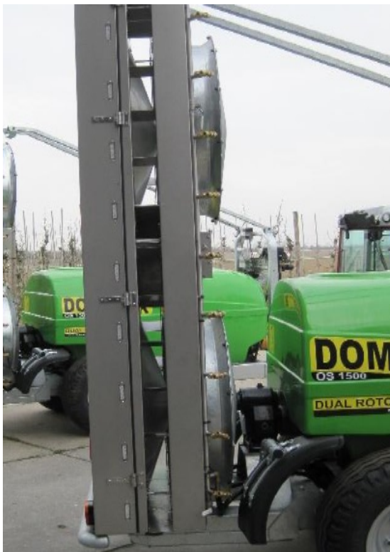
Figuur 3 De luchtklep (DRS-klep) van de Dominiak dwarsstroomspuit. De grootte van de luchtuitstroomopening kan links en rechts onafhankelijk worden ingesteld met de terminal in de cabine van de tractor. Op de foto is de DRS-klep 100% geopend.
