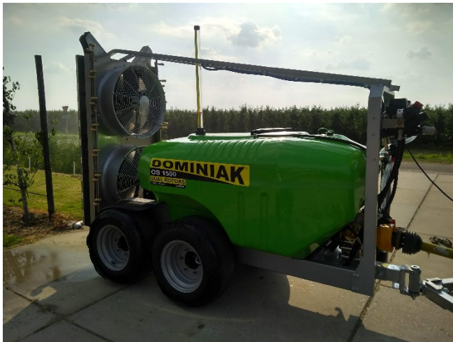
Figuur 1 Dominiak dwarsstroomspuit Rechte mast (linker foto boven), Hollandse mast (rechter foto boven), Franse mast (linker foto onder) en Zachfruit mast (rechter foto tekening onder). Afmeting (diameter) ventilatoren: Rechte mast beide ventilatoren 80 cm, Hollandse mast onderste ventilator 80 cm en bovenste ventilator 62 cm, Franse mast beide ventilatoren 70 cm en Zachfruit mast beide ventilatoren 59 cm.
