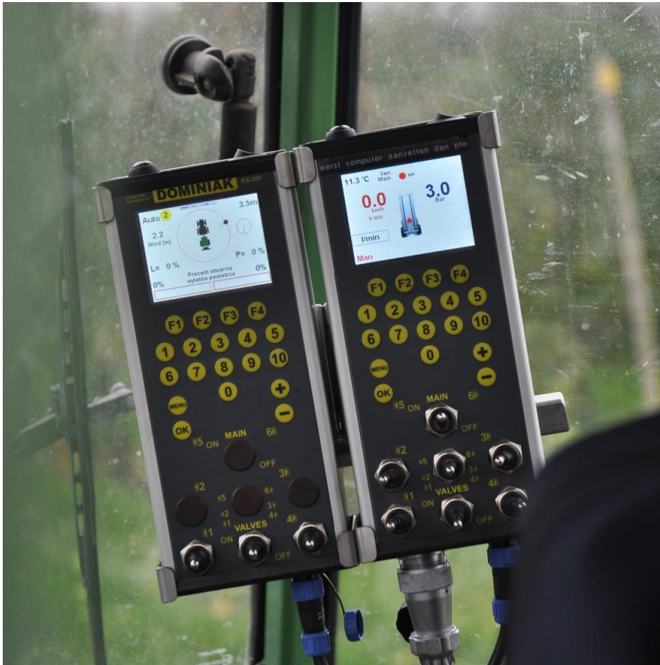
Figuur 6 In de cabine van de tractor zitten twee terminals: 1. De linker terminal regelt de instelling van de luchtkleppen 2. De rechter terminal regelt het spuiten (o.a. spuitdruk zichtbaar)
