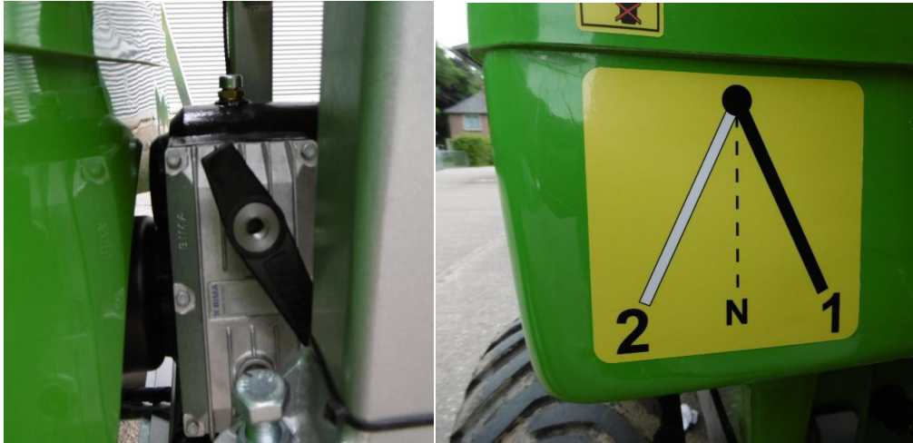
Figuur 4 De versnellingsbak van beide ventilatoren wordt door middel van een hendel in de juiste luchtinstelling gezet: Stand 1 voor lage luchtinstelling Stand 2 voor hoge luchtinstelling Stand N voor Neutraal = uitgeschakeld
