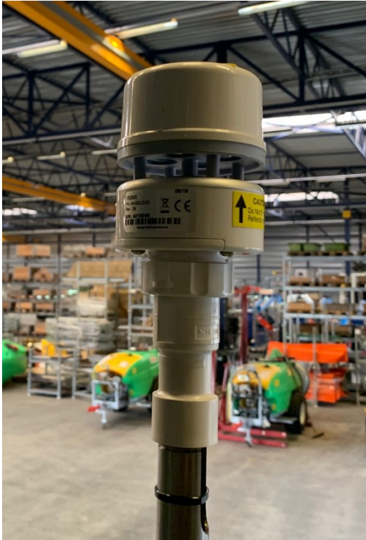
Figuur 3 Afbeelding weerstation/windsensor
