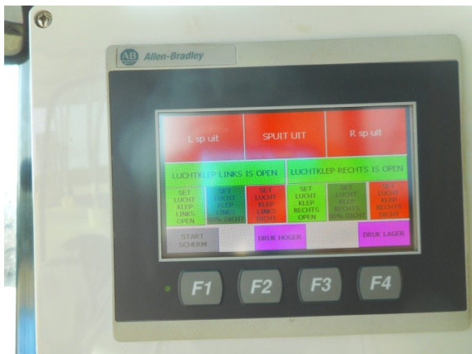
Figuur 3 Scherm van spuitcomputer met touchscreen met daarop per spuitrichting (links en rechts) knoppen voor de bediening van de luchtklepinstelling: OPEN (lichtgroen), 80% DICHT (donker groen) en DICHT (rood).
