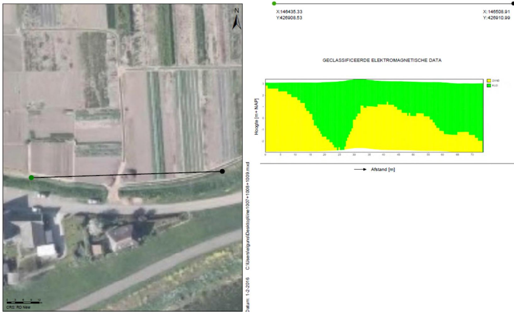
Figuur 7: Voorbeeld lengteprofiel met dikte van deklaag uit de EM data van figuur 4.
