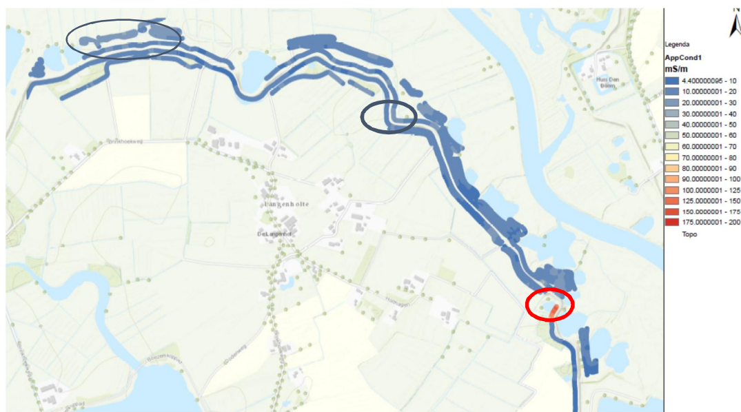
Figuur 5: Voorbeeld contourbeeld van EM data in gebied 1 (Langenholterdijk) tot een diepte van 2.2 m -MV.
