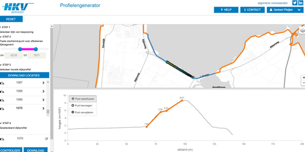
Figuur 3: Schematisatie van een dwarsdoorsnede (oranje profiel) en het AHN (grijze profiel).
