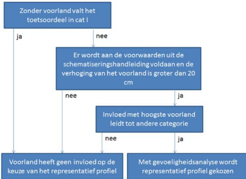
Figuur 6: Werkproces bij de van bepaling van de impact van voorlanden.
