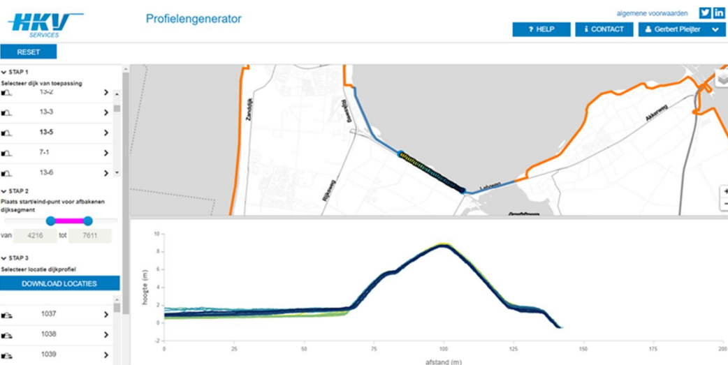
Figuur 2: Analyse dwarsdoorsneden op basis van AHN2.
