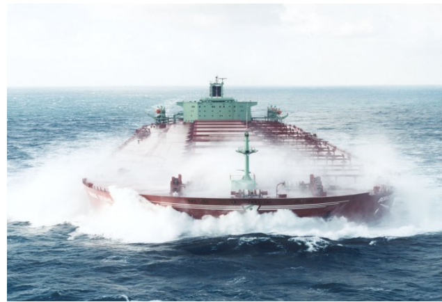
Ertscarrier 'Berge Stahl' nadert Rotterdam dit schip steekt wel 23 meter diep
