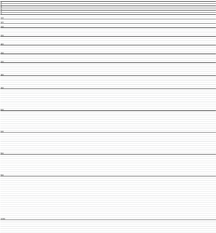
Figuur 2.5 Verticale schematisering: fijne schematisering nabij het maaiveld, grover naar beneden.
