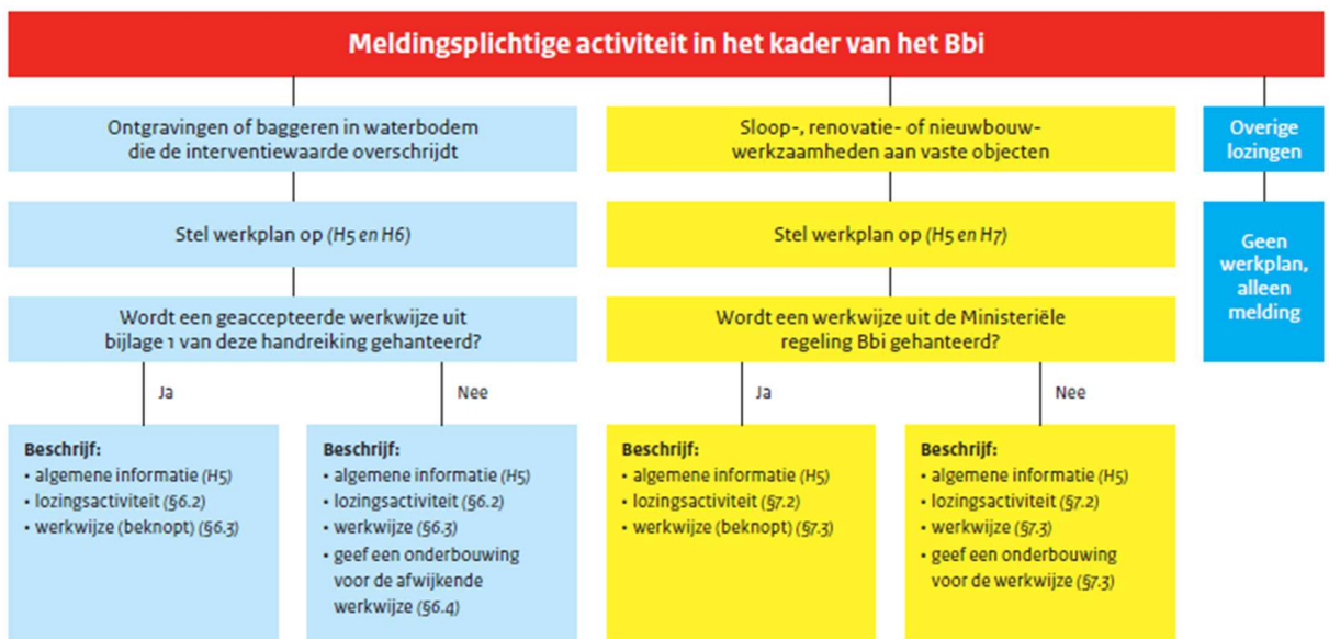
Figuur 1: Opzet en inhoud van werkplan Bbi. De paragrafen/hoofdstukken verwijzen naar de toelichting in deze handreiking.
