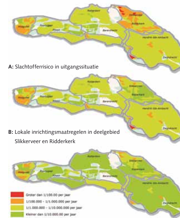
Afbeelding 2: Het slachtofferrisico (LIR) kan door verschillende maatregelen binnen een dijkkring worden verminderd
