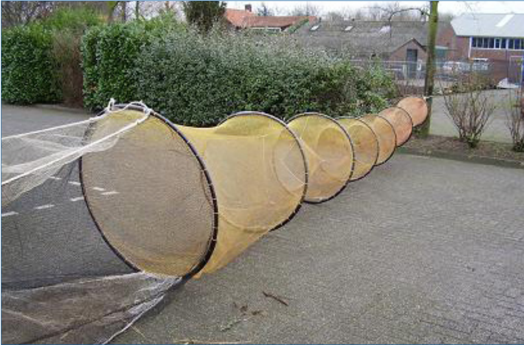
Figuur 5 Voorbeeld grote hokfuik zoals gebruikt in dit onderzoek.
