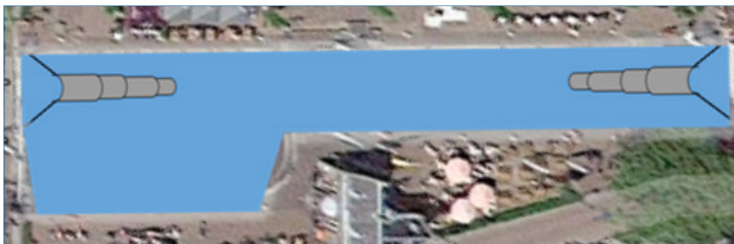
Figuur 3 Schematische weergave van de twee fuike in sluis Leidschendam.
