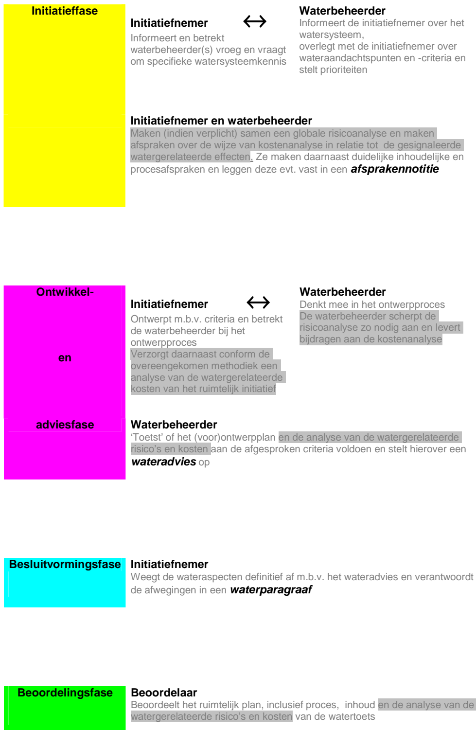
Figuur 4.1: Het proces van de watertoets schematisch weergegeven (inclusief risico- en kostenanalyse; de toevoegingen als gevolg van de risico- en kostenanalyse zijn in grijs weergegeven)
