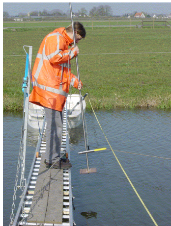
Figuur 3.9 Afvoermeting. (foto RPS)
