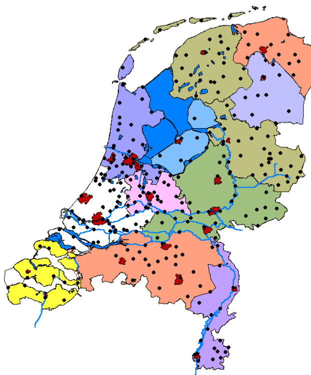
Figuur 2 Rioolwaterzuiveringstallaties in Nederland (installaties groter dan 10.000 i.e. en enkele kleinere installaties op Waddeneilanden)
